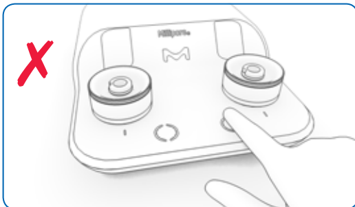
Abbildung 4: FALSCHER Fingerposition – keine Aktivierung, da der Finger die Umrandung berührt
