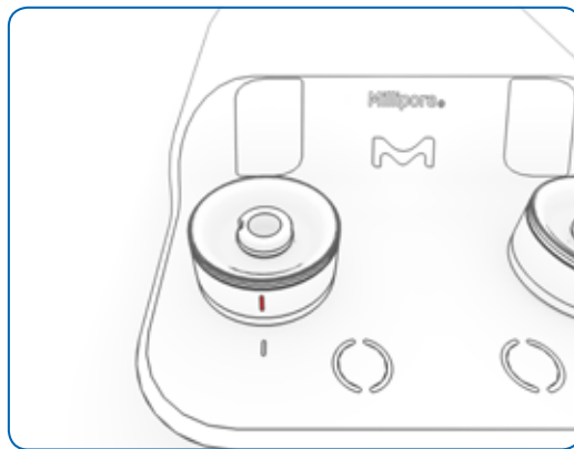
Abbildung 33: Die Markierung auf einem arretierten Pumpenkopf ist auf die Markierung am Pumpenkörper ausgerichtet
