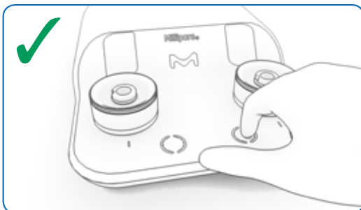
Abbildung 5: KORREKTE Fingerposition zum Starten oder Stoppen der Pumpe
