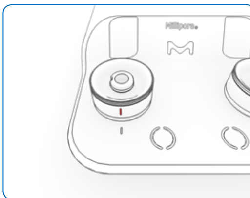
Abbildung 11: Die Markierung auf einem arretierten Pumpenkopf ist auf die Markierung am Pumpenkörper ausgerichtet.
