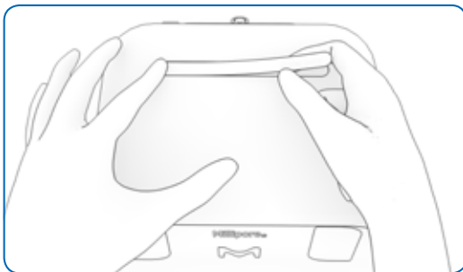
Abbildung 6: Anbringen des Pumpenaufklebers
