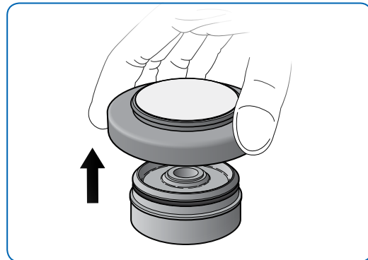
Abbildung 18: Abnehmen des Unterteils der Filtrationseinheit
