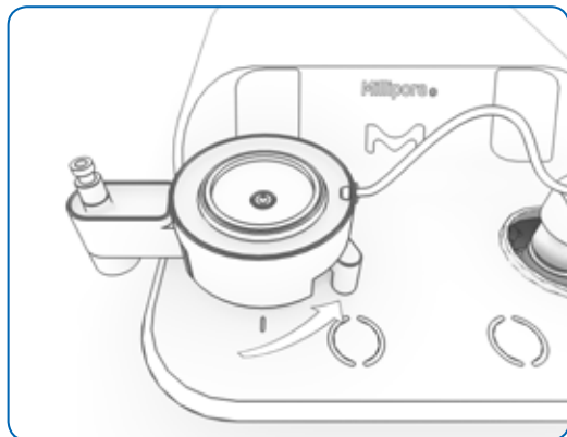
Figure 20 : La gâchette est tournée dans le sens inverse des aiguilles d'une montre
