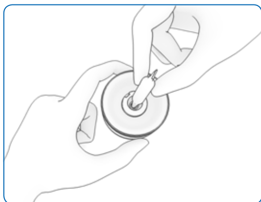
Figure 27 : Installation du clapet anti-retour à l'aide de l'outil – 2 e partie
