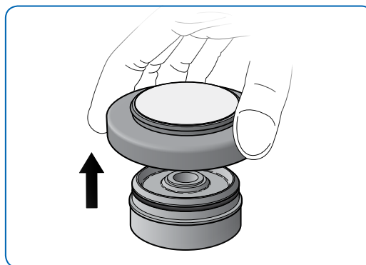
Figure 18 : Retrait de la base de l'unité de filtration
