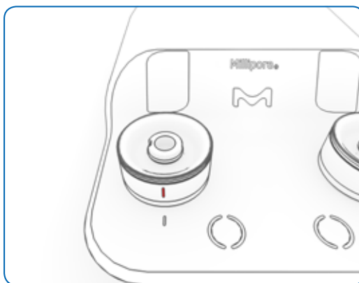
Figure 33 : La marque sur une tête verrouillée est alignée avec celle du corps de la pompe
