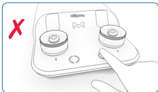
Figure 4 : INCORRECT – aucune activation si le doigt touche l'anneau externe
