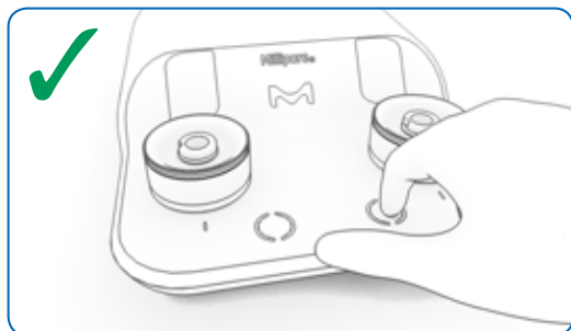
Figure 5 : Position CORRECTE du doigt pour démarrer ou arrêter la pompe
