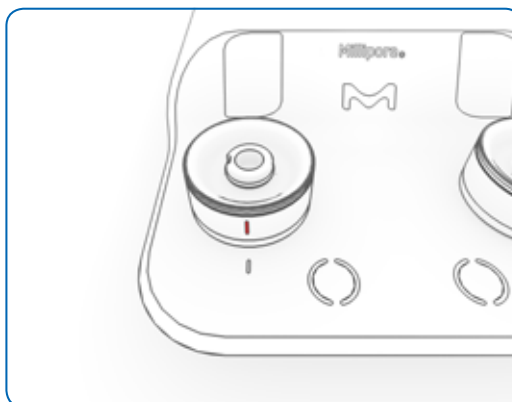
Figure 11 : La marque sur une tête verrouillée est alignée avec celle du corps de la pompe
