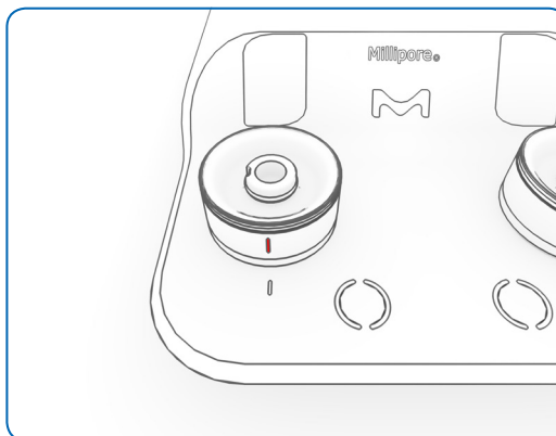
Figura 11: en un cabezal bien apretado, el signo está alineado con el del cuerpo de la bomba
