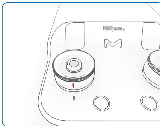
Figura 33: en un cabezal bien apretado, el signo está alineado con el del cuerpo de la bomba
