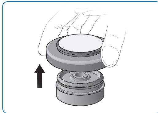
Figure 18: retirada de la base de la unidad de filtración
