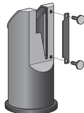
При использовании ампул без насечки на горлышке следует установить на контейнер дополнительный напильник, покрытый алмазной крошкой (см. «Информацию для заказа»).
