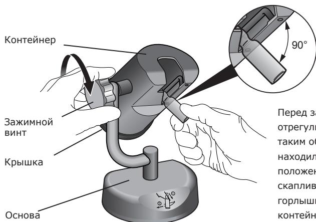
Перед затягиванием зажимного винта отрегулируйте угол наклона контейнера таким образом, чтобы ампула находилась в максимально вертикальном положении. Это предупреждает скапливание остаточной жидкости в горлышке ампулы. Угол между ампулой и контейнером должен быть около 90 градусов.
