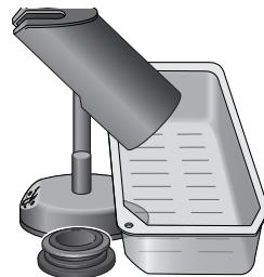
Снимите нижнюю крышку при заполнении контейнера и удалите верхушки ампул непосредственно в пустой блистер Steritest™ для утилизации. Также крышку можно оставлять открытой, чтобы верхушки постоянно проходили через контейнер и собирались в блистер для утилизации.
