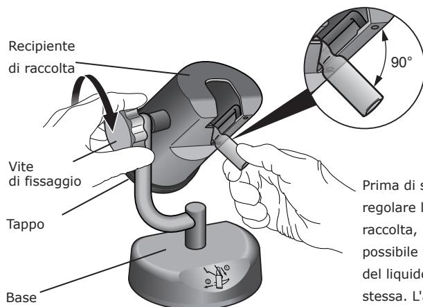
Prima di stringere la vite di fissaggio, regolare l'angolazione del recipiente di raccolta, in modo che la fiala sia il più possibile verticale. Si evita, così, che parte del liquido si raccolga nel collo della fiala stessa. L'angolo formato dalla fiala con il recipiente di raccolta deve essere di circa 90 gradi.
