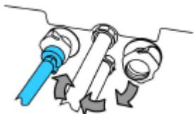
5. 如果已安装外部电磁阀，打开进水阀旋钮。
