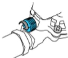
6. 打开终端过滤器排气孔，以便排气。有水流出时将其关闭。
