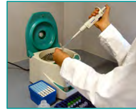
3. Zentrifugieren/Zelllyse (2 ml Probe, 13.000 rpm; 37°C, 45-60 min)
