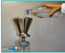
1. Probe filtrieren (1000 ml Wasser, 15 min)
