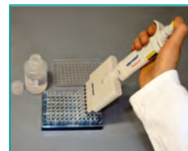
6. Enzymreaktion (Kopplung des Enzyms an das „Sandwich“, 25 min)
