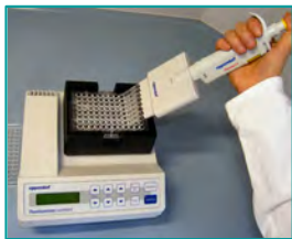
7. Waschen (Entfernen ungebundener Komponenten, 2x1 min)
