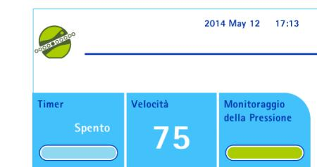
Identica alla modalità con monitoraggio della pressione a cui si aggiunge la regolazione automatica della velocità della pompa per ridurre la pressione nei canister.
